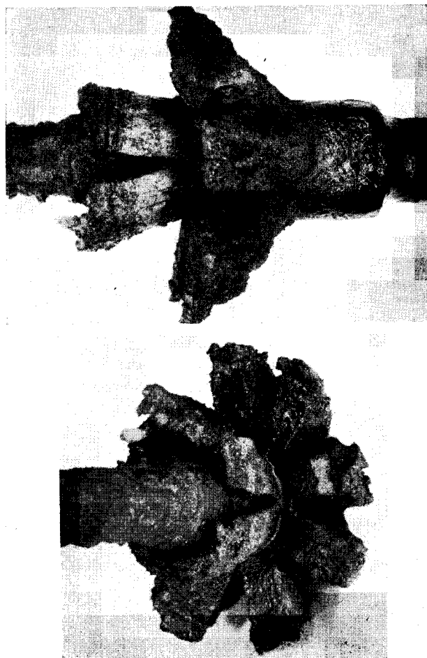
Bild 9. Hartzinkbildungen am Einspannkopf oberhalb der Zerreißprobe
