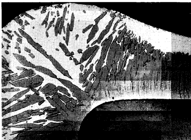
Bild 9. Zinküberzug an einer Ecke (rd. 100 : 1)
