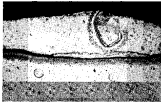
Bild 11. Querschnitt durch die Zink- schicht eines Bleches mit strich- förmig angeordneten Pickeln (75 : 1)
