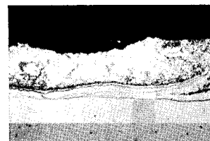
Bild 10. Längsschliff durch die Zinkschicht eines Bleches mit strichförmig angeordneten Pickeln (rd. 100:1)
