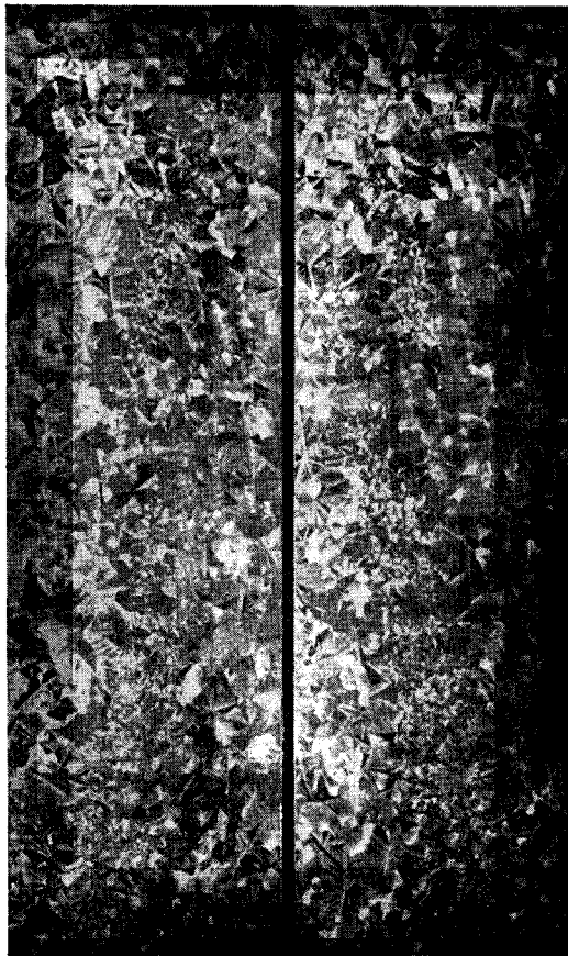
Bild 11. Feinblumige Blitze auf beiden Blechseiten in spiegelbildlicher Form und Anordnung (0,25 : 1)
