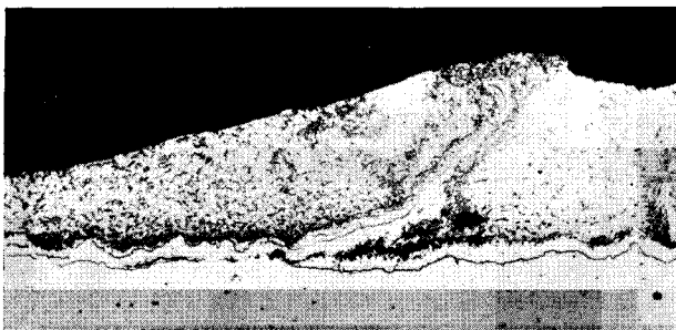
Bild 4. Schliff durch den Zinküberzug eines Blitzes mit rauher Oberfläche (100:1)
