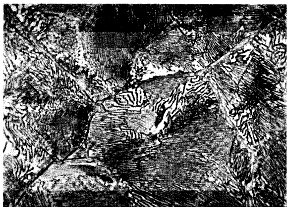
Bild 1c. 1,38 % C, \frac{1}{2} h 1050°/Ofenabkühlung
