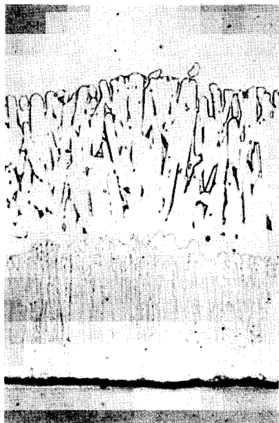
Bild 9a. 0,47 % C, lamellarer Perlit, 450° 1 h 200 : 1
