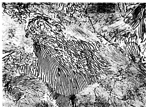
Bild 1b. 0,88 % C, \frac{1}{2} h 750°/Ofenabkühlung
