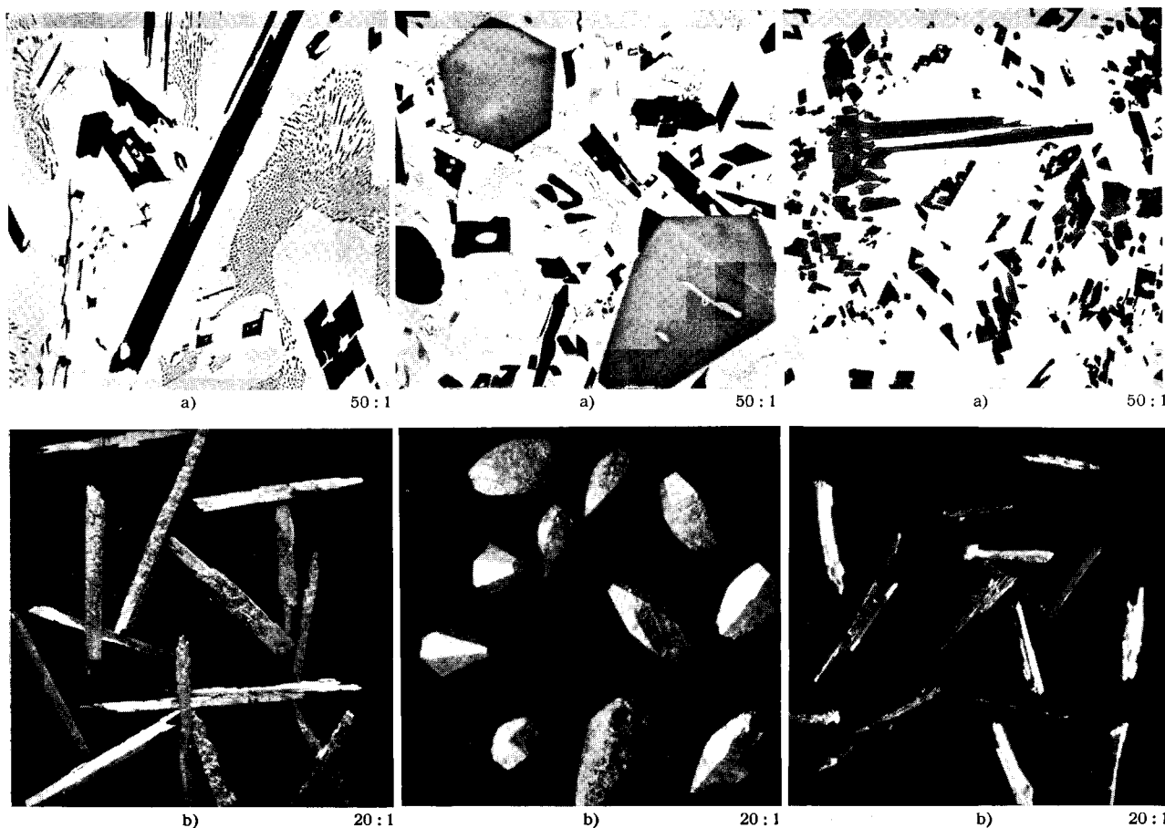
Bild 1. a) Gefüge, b) isolierte \zeta -Kristalle einer Zink-Mangan-Legierung
