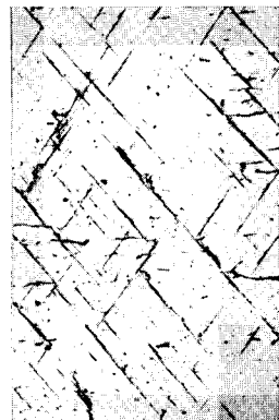
b) verzinktes Blech 1: Zinküberzug ( \sigma_a = \pm 28,6 \text{ kg/mm}^2 ; 100:1)
