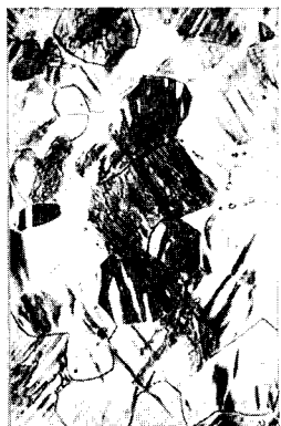
a) nicht verzinktes Blech 1: Eisenoberfläche ( \sigma_a = \pm 27,1 \text{ kg/mm}^2 ; 500:1)
