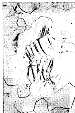
a) nicht verzinktes Blech 1: Eisenoberfläche ( \sigma_a = \pm 27,1 \text{ kg/mm}^2 ; 500:1)
