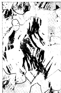
a) nicht verzinktes Blech 1: Eisenoberfläche ( \sigma_a = \pm 27,1 \text{ kg/mm}^2 ; 500:1)
