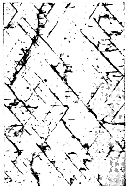
Bilder 8a und b. Entwicklung von Gleitlinien und Anrissen in Abhängigkeit von der Beanspruchungszeit (Oberfläche leicht poliert)
