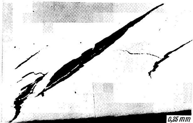
11 Verwindungen (Probe gebrochen; rd. 30:1, Original 40:1)
