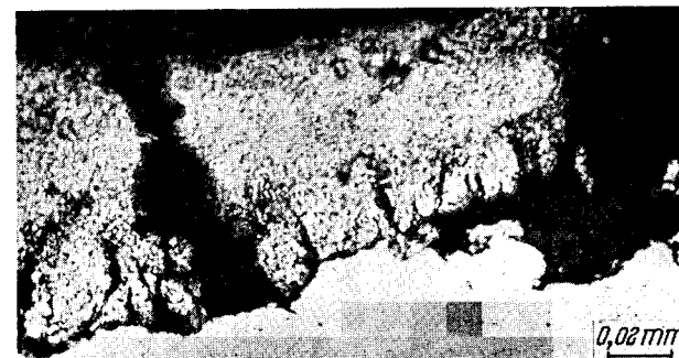
d) in der Einschnürzone nach dem Bruch
