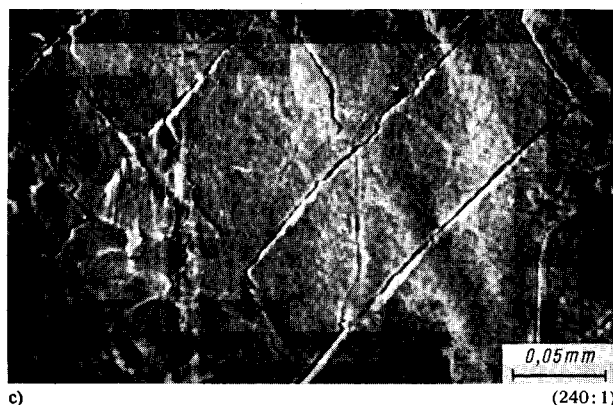
Bilder 14 a bis d. Gleitlinien und Rißbildung auf der Oberfläche wechselbeanspruchter, verzinkter Stahldrähte bei Betrachtung im Rasterelektronenmikroskop
