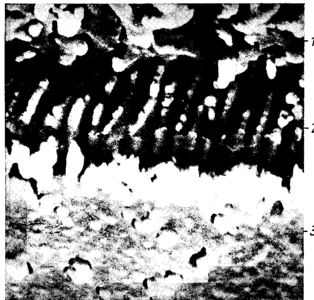
1 FeZn-Legierungsschicht; 2 Perlitlamellen; 3 Stahl C 45 Bild 12. Rasterelektronenoptische Aufnahmen der Grenzschicht zwischen einem perlitischen Stahl und der Eisen-Zink-Legierungsschicht 21) (rd. 500:1)
