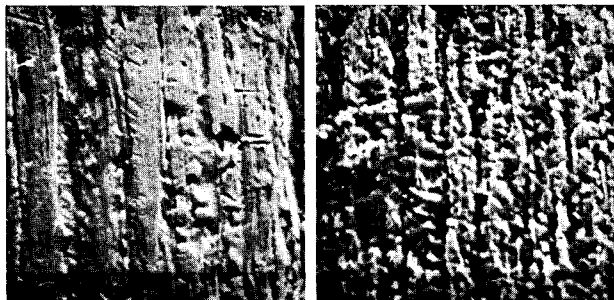
a) Stahl A: 3. Vorbehandlung b) Stahl C: 3. Vorbehandlung Bild 11. Rasterelektronenoptische Aufnahmen der gebeizten Drahtoberfläche (200:1)
