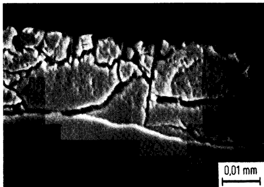
Bild 6. Rißverhalten der Zinkauflage feuerverzinkter Spannstähle bei Stauchung; Stauchgrad rd. 10%
