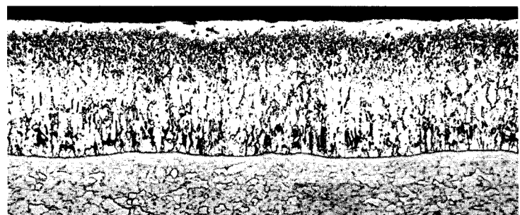
Abb. 4: Gefüge des Zinküberzuges auf dem beruhigten Stahl mit 0,54 % Si (100:1)
