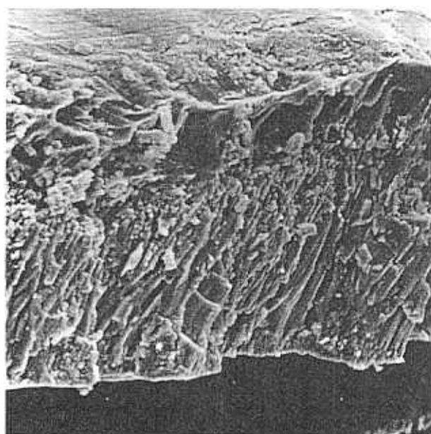
Abb. 2.2: Bruch der Zinkauflage eines verzinkten Spannstahls (1000 : 1)
