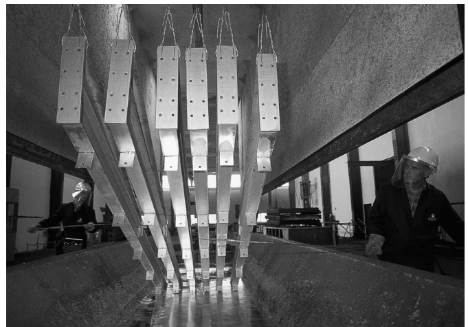
Bild 1. Feuerverzinken von Stahlbauteilen (Foto: Seppeler-Gruppe/Feuerverzinkung Paul Heinemann) Fig. 1. Hot dip galvanizing of steel structures (Photo: Seppeler-Gruppe/Feuerverzinkung Paul Heinemann)
