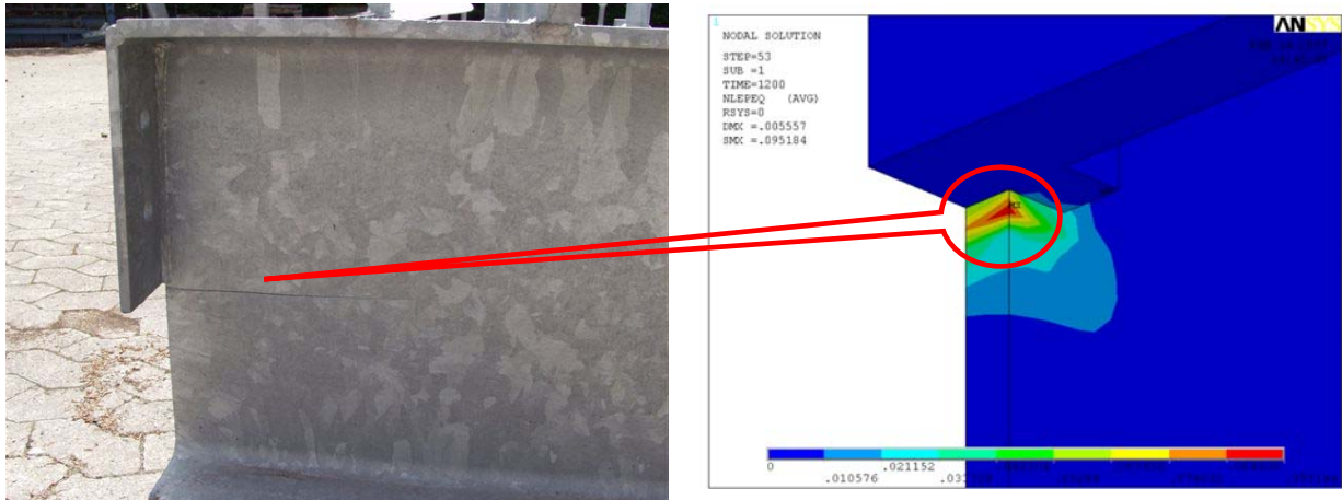
Bild 9-4: Örtliche Dehnungen unterhalb der Teilkopfplatte eines I-Profils beim Eintauchen in flüssige Zinkschmelze
