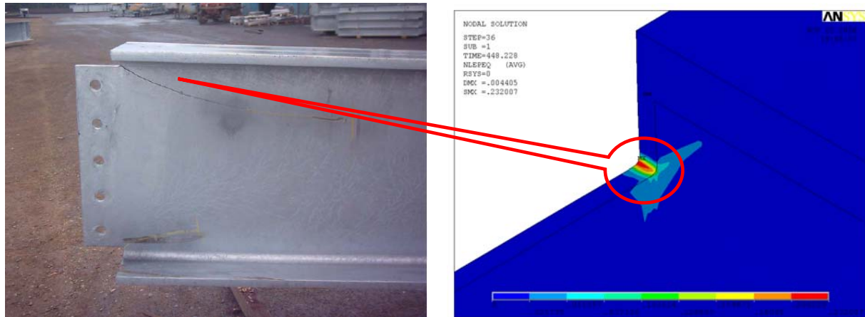
Bild 9-6: Örtliche Dehnungen an der Ausklinkung eines I-Profilen beim Eintauchen in flüssige Zinkschmelze
