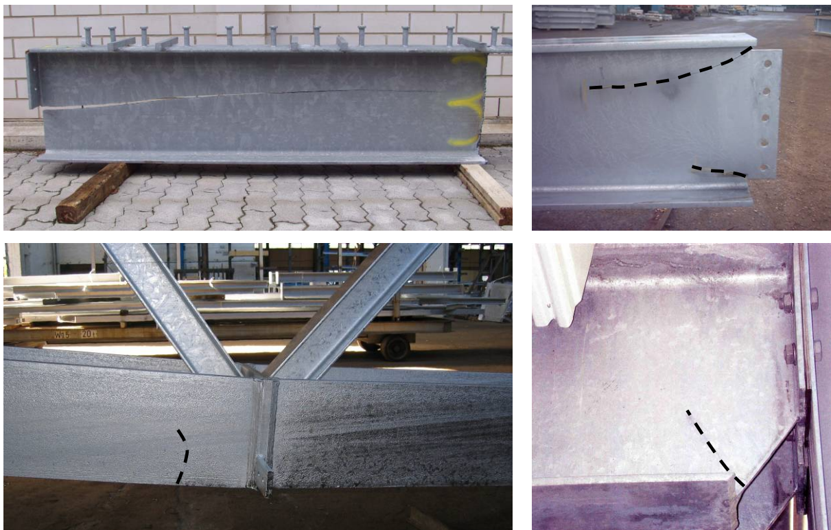
Bild 3-8: Beispiele für Risschäden beim Feuerverzinken
