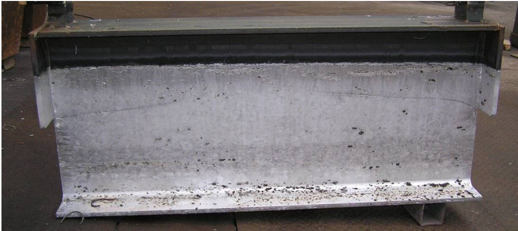
Bild 7-2: Großprobentauchversuch IPEa550 – Probekörper nach dem Eintauchen
