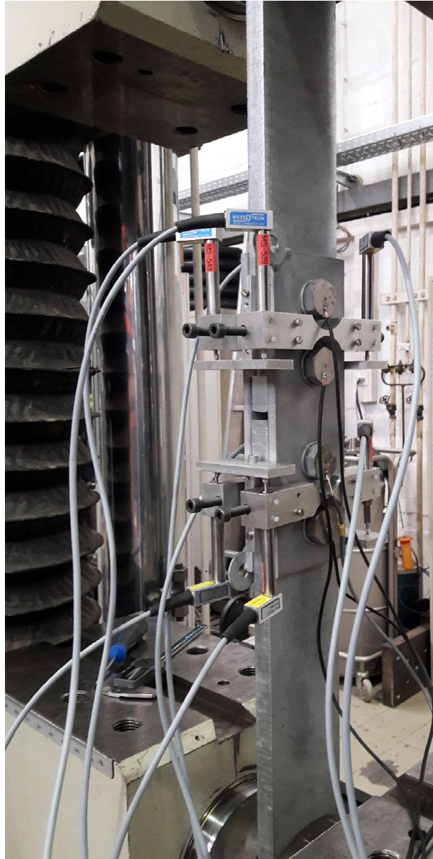
Abbildung 9 Versuchsaufbau der quasi-statischen Prüfung inkl. Messinstrumente
