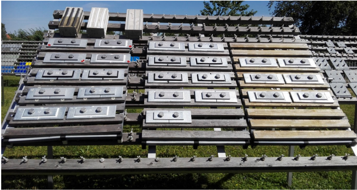
Abbildung 21: Auslagerungsgestell in natürlicher Freibewitterung Dresden
