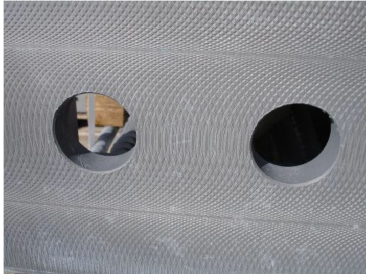
Abbildung 5 Beispiel einer mechanischen Reibflächenvorbereitung an einer Lasche mit nachträglicher HT-Verzinkung
