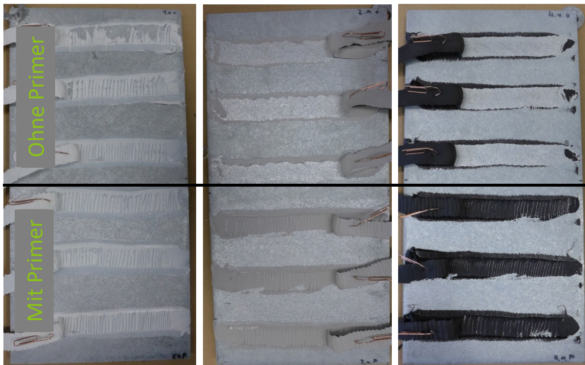
Abbildung 18: Bruchbilder der Dichtstoffe auf NT-Verzinkung nach AHT-Belastung links: Teroson MS 640, Mitte: Otto Coll P83, rechts: Sikaflex 11 FC
