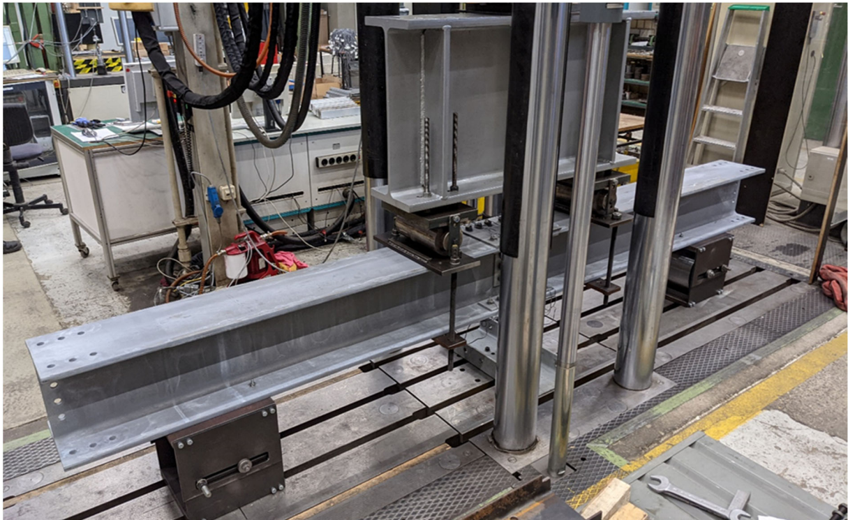
Abbildung 14 Aufbau zur Untersuchung von brückenbautypischen, feuerverzinkten Trägern mit GV-Verbindungen
