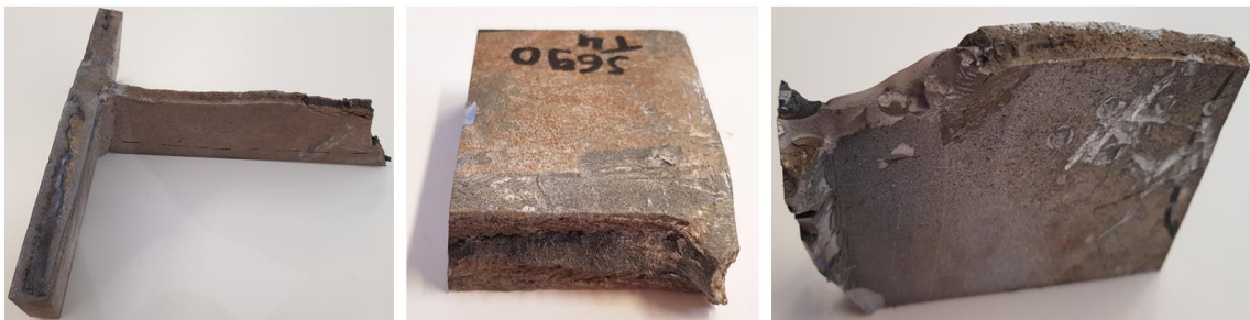
Abbildung 5-10: Proben aus dem unteren Flansch und Steg von Träger 4 für die metallographischen Untersuchungen (Probe 1 links; Probe 2 Mitte; Probe 3 rechts)
