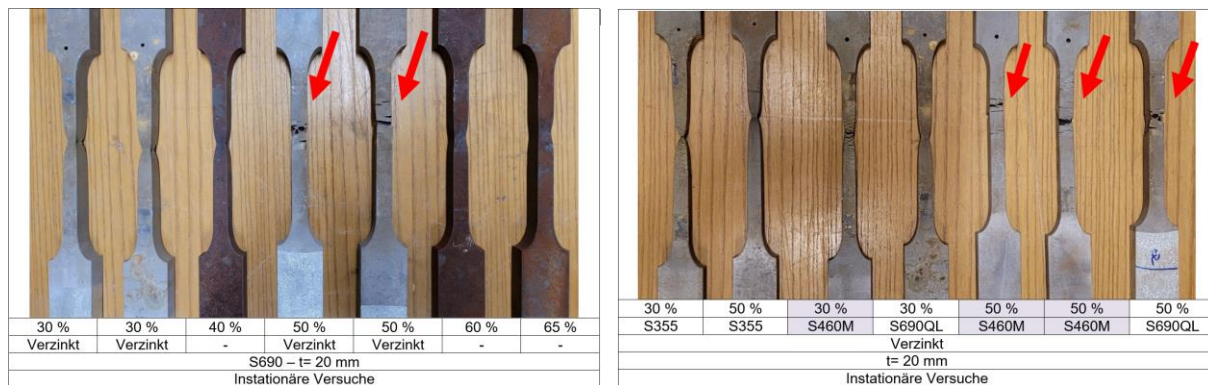
Abbildung 2-3: Vergleich Bruchverhalten instationäre Versuche S690 verzinkter und unverzinkter Probekörper
