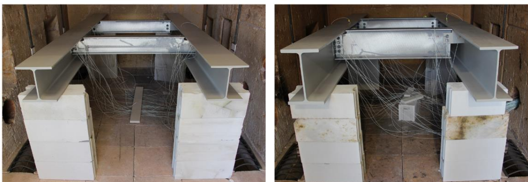
Abbildung 7-3: Versuchsaufbau Nr.1 (links) und Nr.2 (rechts) vor dem Brandversuch [26]
