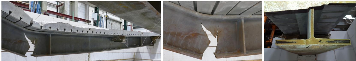
Abbildung 5-8: Risse und Bruchflächen im unteren Flansch und Steg von Träger 4
